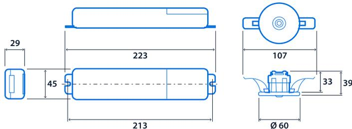
Profondeur de vide minimum (en passant au travers de la découpe du contrôleur) = 225
